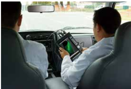
CoCo-80X进行CAN总线测量
